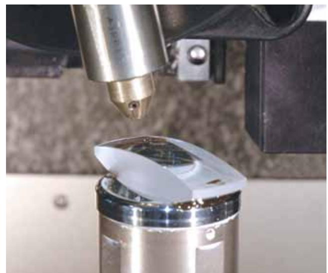
Mesure d'un segment de lentille asphérique
